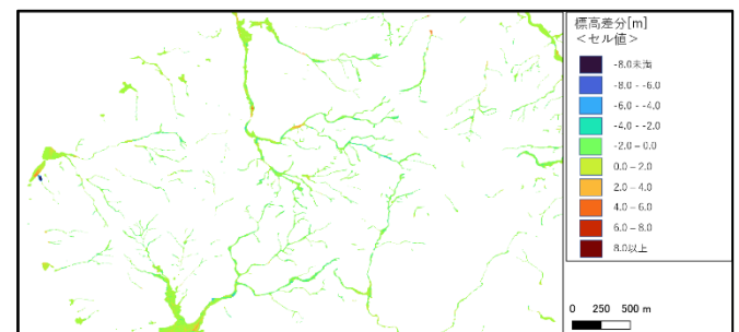
図-1: 2018年の土砂災害前後におけるLiDARの標高差分
