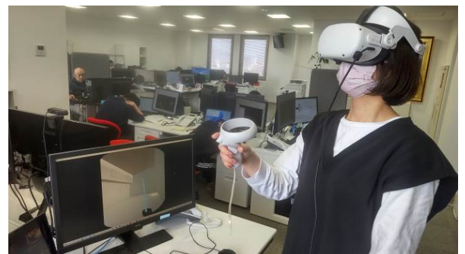
Fig. 6 VR ヘッドセットにて操作性を検証
