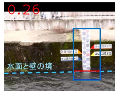
図 5 水位計測画面 (青枠:計測エリア 赤線:水位)
