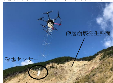
写真-2 ドローン空中電磁探査の様子。地表に敷設したケーブルに電流を流して磁場を発生させ、ドローンに吊した磁場センサーで地下の鉛直成分の磁場を測定する。
