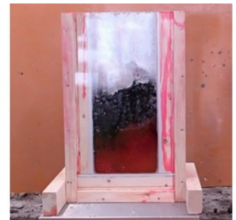
図-1 火砕物と雪が混合することで激しく融雪が進んでいる様子
