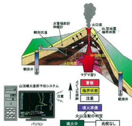
図4 観測坑道による計測概念図 5)
