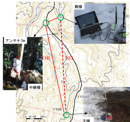
図5 中継子機を用いた調査ユニットデータの受信
