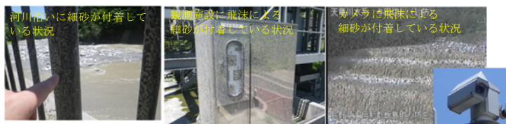
図 4 観測所周辺で確認された土石流の痕跡
