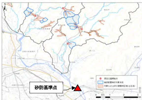
図-3 土砂・洪水氾濫への影響が大きい溪流
