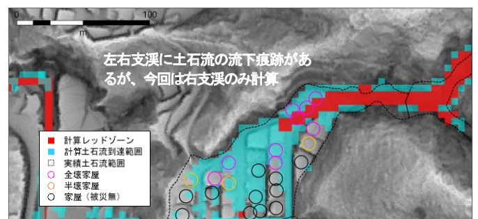
図4 複数回の土石流が影響した可能性がある溪流
