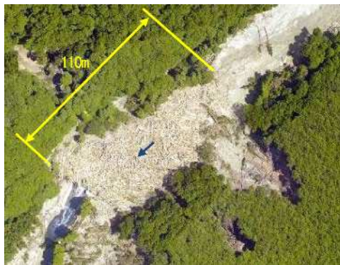
写真-1 不透過型砂防堰堤の流木捕捉状況 4)
