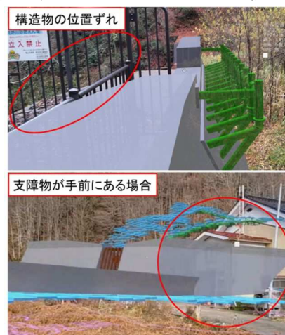
図6 CIMモデル投影 位置ずれ・支障物がある場合
