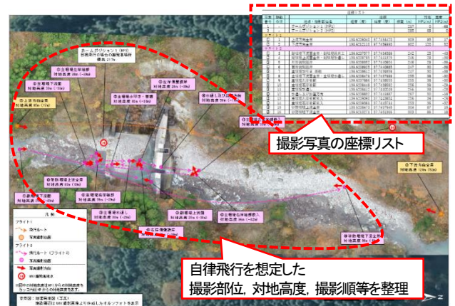
図-6 飛行計画作成例（実川第1号砂防堰堤）
