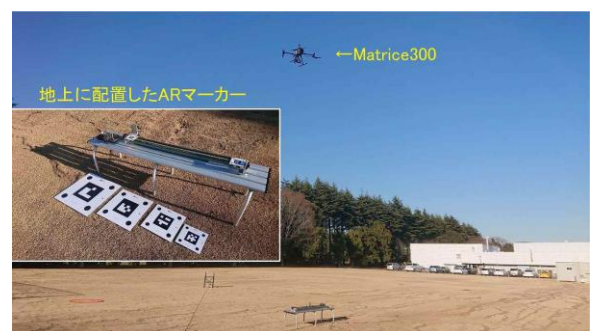
図 3 撮影に用いた UAV と AR マーカーの配置
