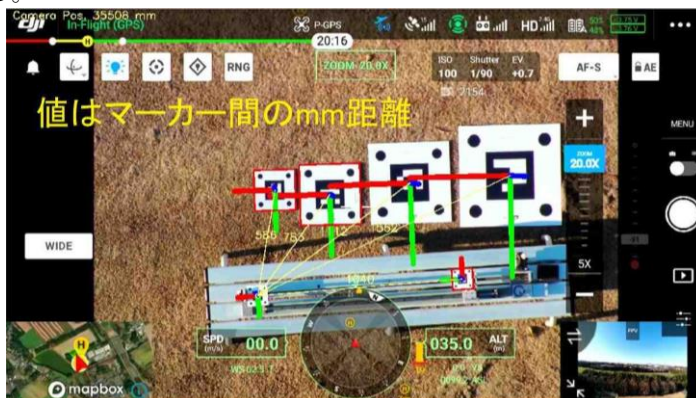
図 4 AR マーカーを用いた画像解析の結果
