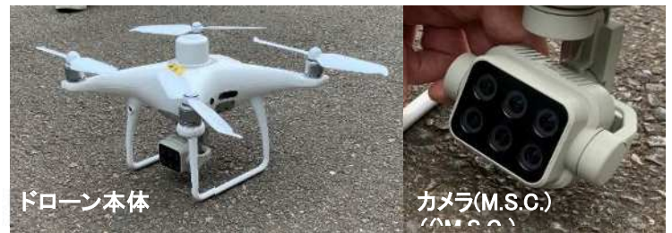
図2 マルチスペクトルカメラ搭載のドローン(DJI社製)
