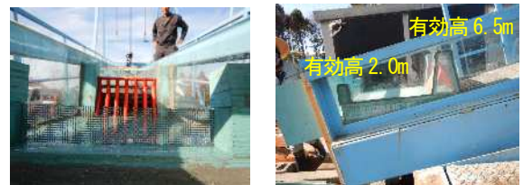
写真-1 新型砂防施設の実験模型（縮尺 S=1/50）
