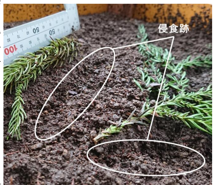
写真-1 表面流による侵食跡
