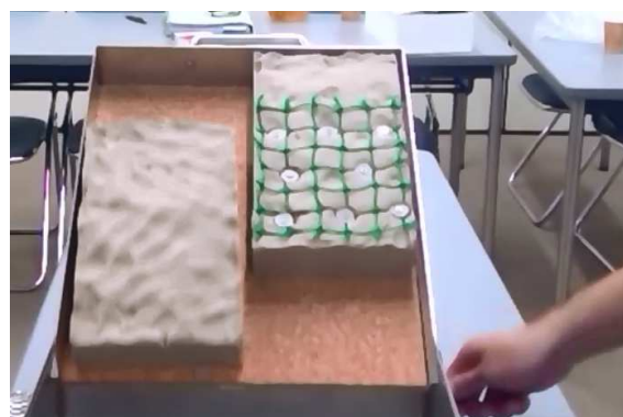
図 4 模型実験を用いた加振実験の状況
