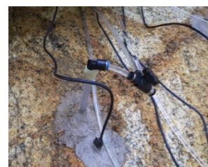
写真2 基岩内テンシオメータ
