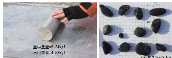
写真-3 適用性試験に使用した錘・河床材料
