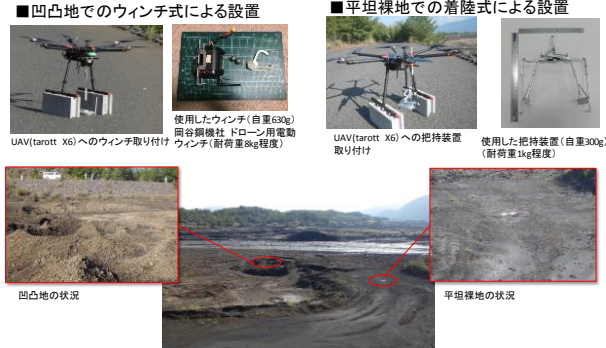
図-3 調査ユニットの設置試験箇所の状況
