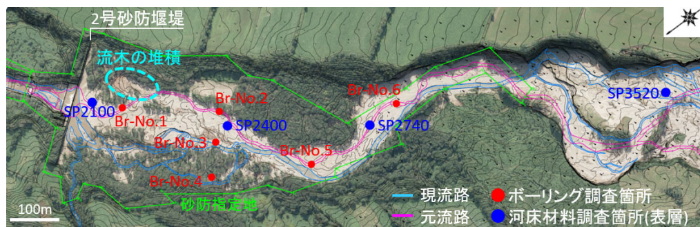
図-1 ペケレベツ川 2 号砂防堰堤堆砂域における調査位置
