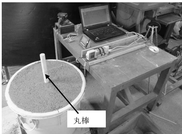
写真2 模型を対象にした引き倒し試験
