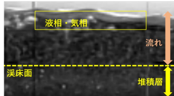
写真-1 土石流先頭部の様子 (流下距離 40cm)
