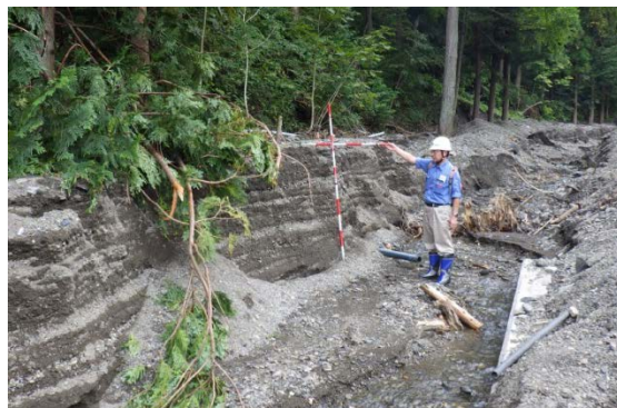
写真 4 氾濫土砂の層状な堆積
