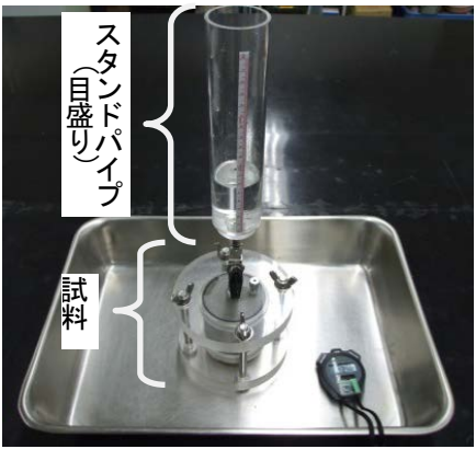
図-2 冠水型試験装置
