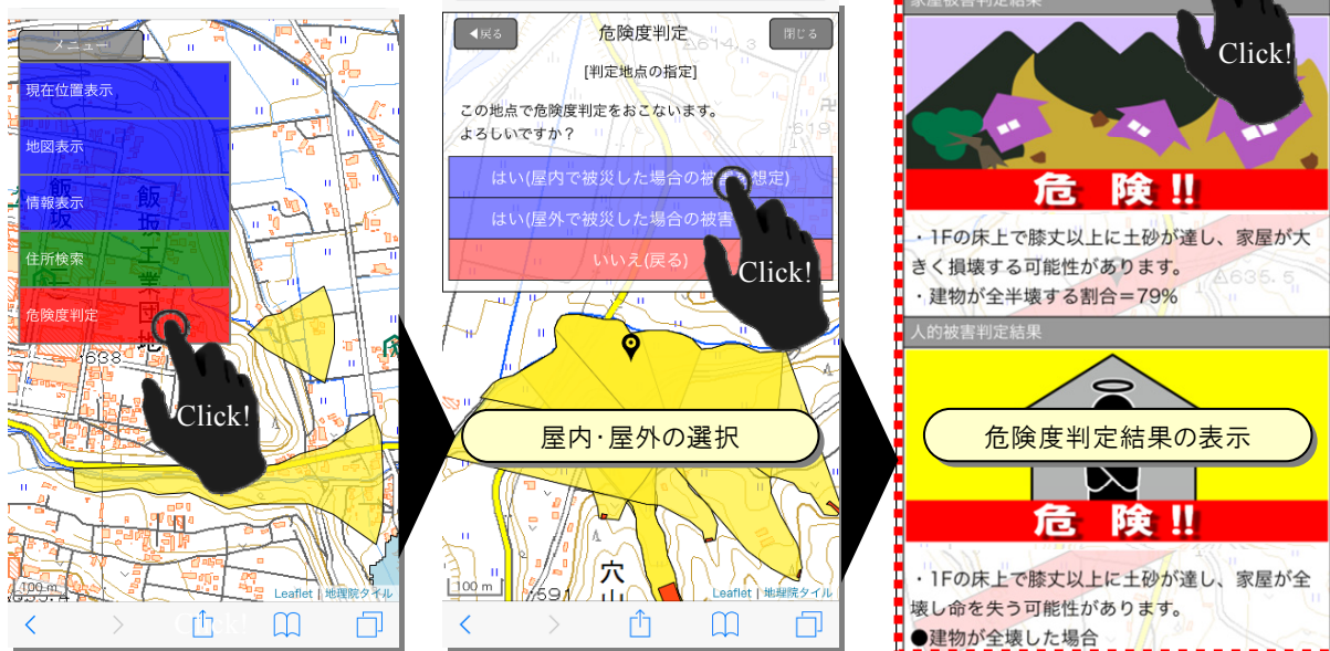
図-4 スマートデバイスによる危険度判定の流れ
