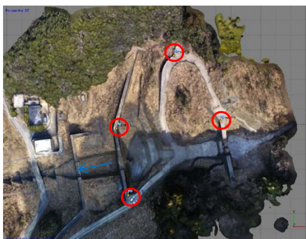
図-5 三次元点群の標定（代替）点
