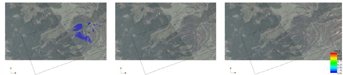
(a) 10 秒後 (b) 150 秒後 (c) 600 秒後 図 6 Case4 (全ての崩壊が同時に発生, 細粒土砂相変化無し) の流動深
