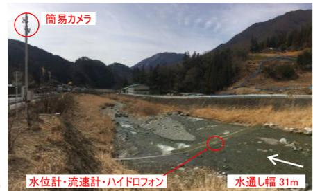
図1 鹿塩川簡易カメラ設置状況
