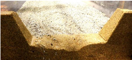
写真- 1 堰堤模型の摩耗状況
