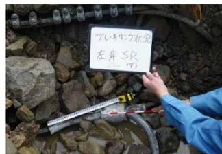
図7 ブレーキリング変形状況
