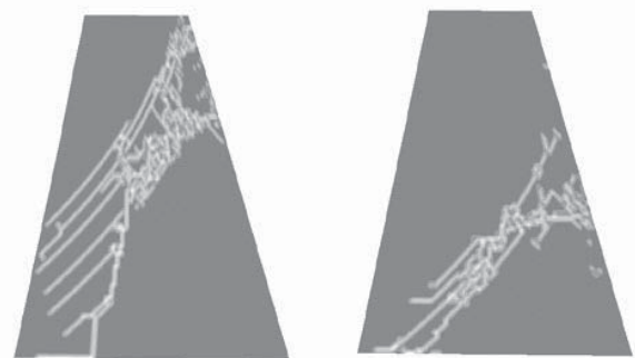
図-6 コンクリート堰堤の破壊状況
