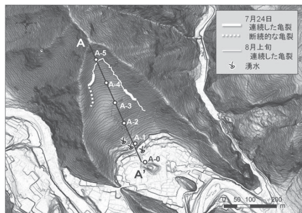
図-1 地すべり発生斜面で認められた亀裂(7月24日)、平成 24 年 12 月 29 日計測 LP データより作成した傾斜量図に等高線を表示
