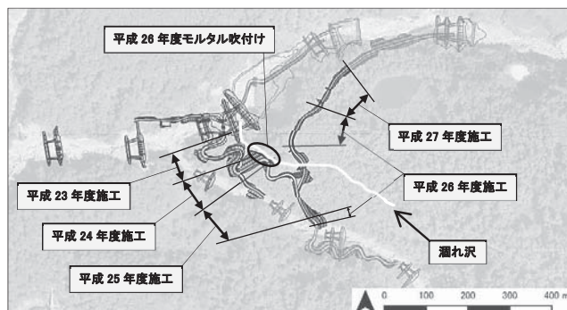
図 4 対象工事の進捗状況
