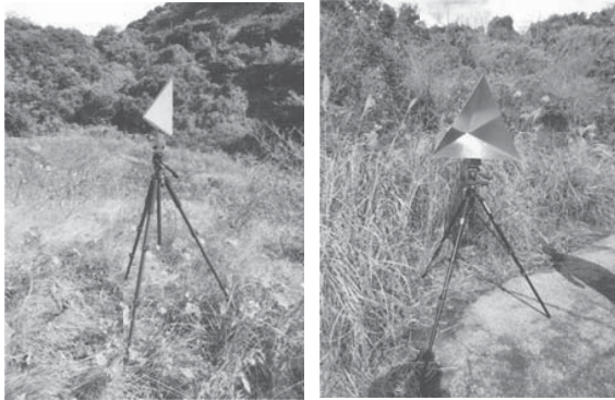
図 4 植生繁茂域に設置した CR (左：40cm 長、右：80cm 長)
