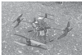
図 1 UAV レーザ計測システム「TOKI」
