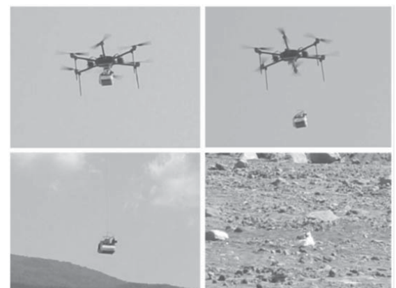
図 5 土砂サンプリングデバイスの降下から接地までの連続写真
