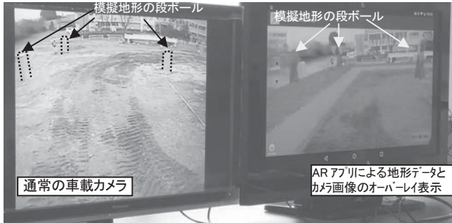
図 4 無人機に搭載した視覚補助システムの画像
