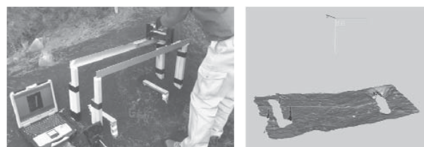
図-6 3D スキャナーを用いた火山灰堆積斜面のスキャン作業状況（左）とスキャン結果（右）
