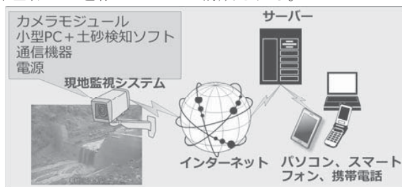
図1 土砂災害検知システム概要
