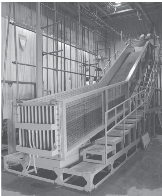
図-1 斜面崩壊実験に使用した大型模型
