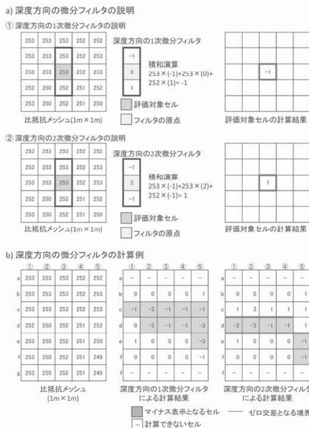
図-1 深度方向の微分フィルタの説明と計算例
