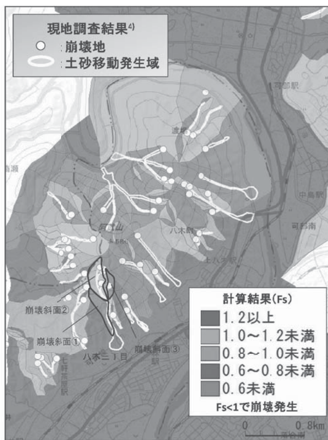
図5 斜面崩壊の発生箇所と斜面の安全率 F_s
