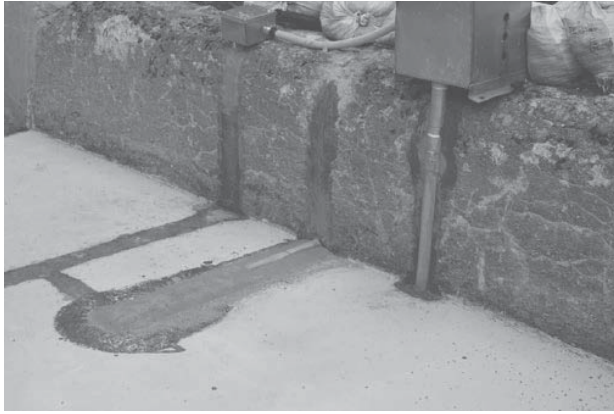
図-2 足洗谷の観測水路に設置された縦・横ハイドロフォンセット
