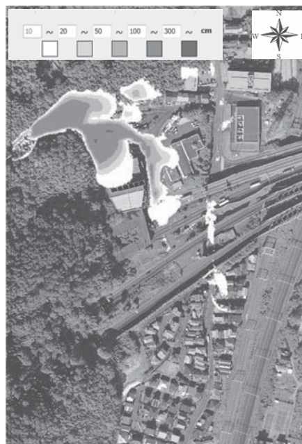
図-2 シミュレーション結果 (家屋および流路工の考慮なし)
