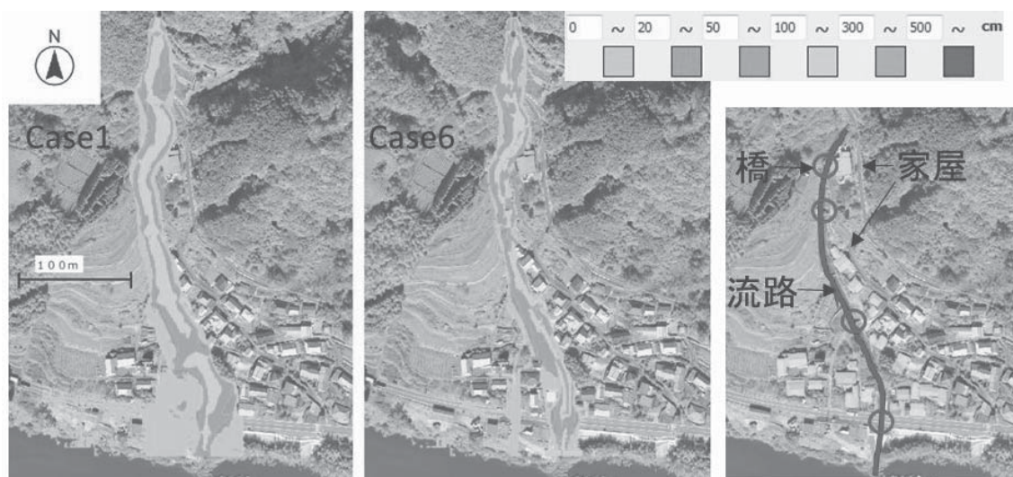
図1：計算終了時の痕跡（左：Case1、中央：Case6、右：考慮した人工構造物の位置）
