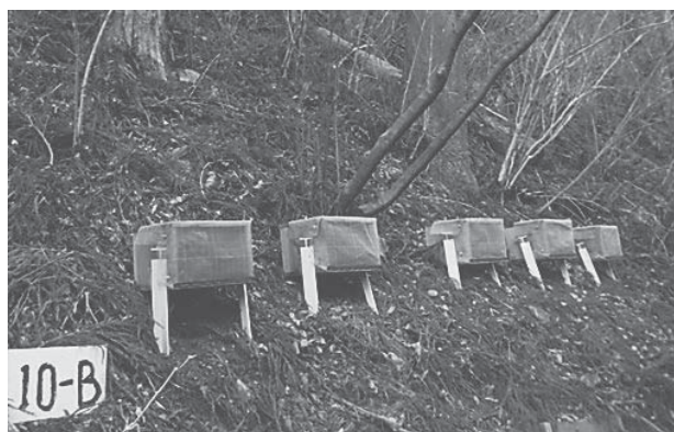
写真-1 土砂受け箱設置状況
