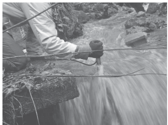
図-3 ポータブルハイドロフォンによる計測の様子
