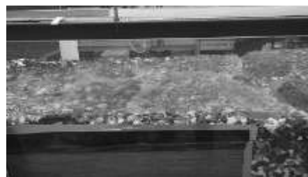
写真 4 原型換算 Q = 34 \text{ m}^3/\text{s} 時の流況
