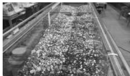
写真 3 えん堤模型下流側の河床状況
